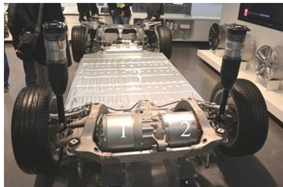
Plateforme TESLA S – 100 kWh : 1-Moteur à induction, 2- Convertisseur électronique 3- Plancher avec 8256 batteries et leur système de refroidissement
