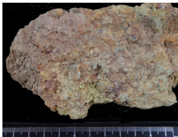
Résidu de traitement par cyanuration d'une mine d'or à arsenopyrite-pyrite. Le résidu montre des traces bleu-vert, liées au cyanure précipité sous la forme de Bleu de Prusse
