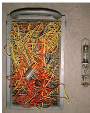
Cette machine est un IBM 604, pour lequel un programme se matérialise en reliant des trous d'un tableau de connexions par des fils munis de fiches ; ces fils sont nombreux car il faut désigner opérateurs et
