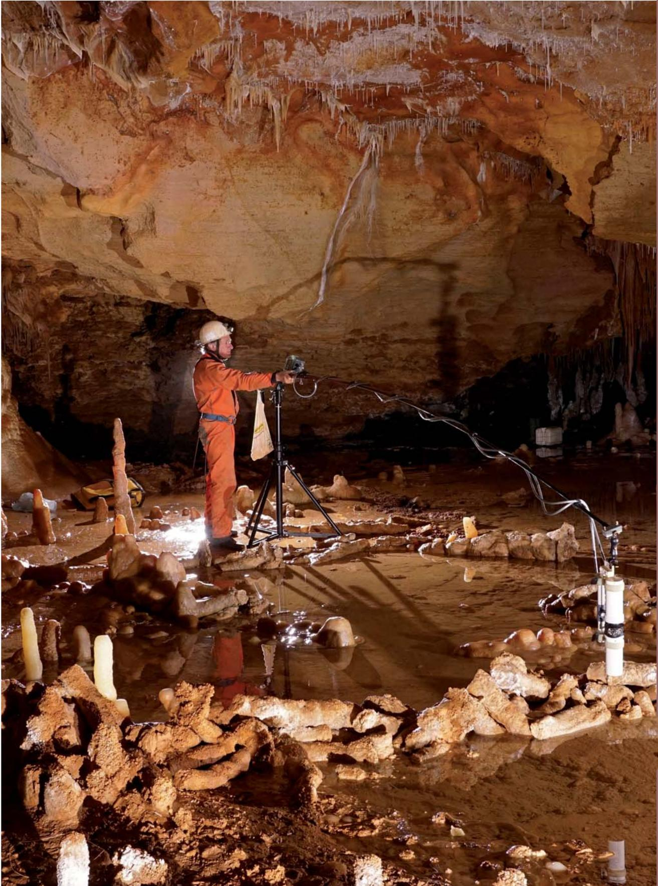
Mise en place d'un dispositif de mesure de champ magnétique dans la grotte de Bruniquel, Tarn-et-Garonne.
